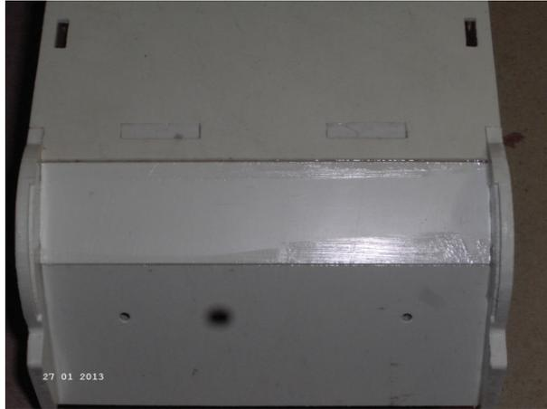
Alle Spalten an den Stoßkanten der einzelnen Teile sollten mit dickflüssigem Sekundenkleber oder Vergleichbarem versehen und somit verklebt und abgedichtet werden.
