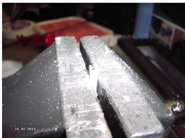
Langes Scharnierteil am langen Steg mittig etwa 1mm breit einfeilen.
