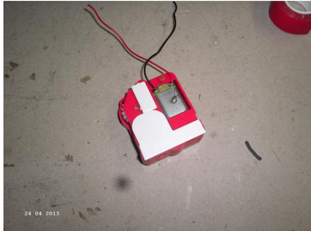
Turmdreheinheit mit 2mm Reststücken unterfüttern.
