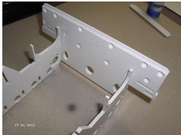
Die Ausfräsungen in den Seitenwänden für den Kettenspanner müssen jeweils nach innen zeigen.
