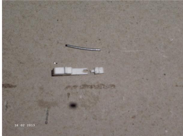
Beide Scharnierteile auf Passung prüfen und mit einem 1mm Draht verbinden.
