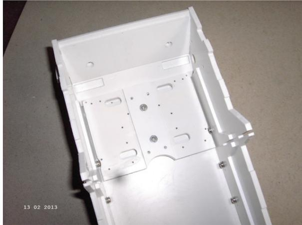
Nach Fixierung mit zwei Schrauben sind die anderen vier Bohrungen mit einem 2mm Bohrer zu übertragen.
