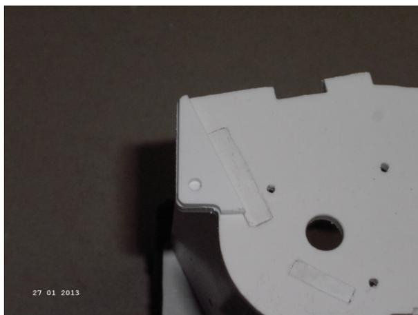
Konturen mit einem Stift übertragen und entsprechend bearbeiten. In diesem Fall entspricht die vorgegebene Form der Ausführung ab 08. Dez. 1942. Daher braucht hier nur die Bohrung übertragen zu werden.
