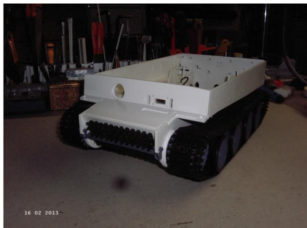
Montage der Frontpartie. Nicht verkleben. Muss für den Zugang zu den Getrieben abnehmbar sein.
