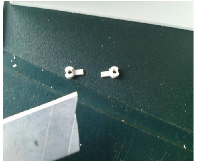
Entfernen Sie jeweils einen Überhang an den Fensterlagern. Danach Kleben Sie diese, wie auf der folgenden Abbildung zu sehen an die Fahrerhaus Front.
