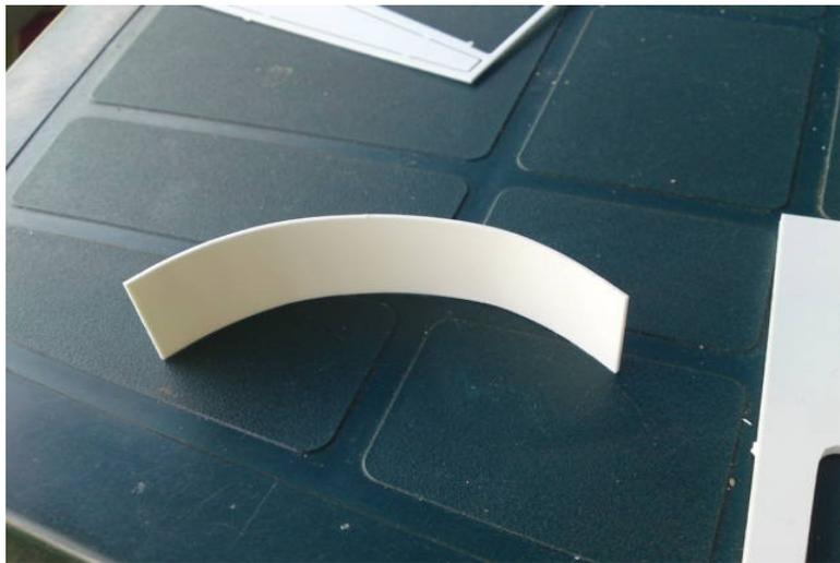
Bringen Sie zunächst erst einmal den Polystreifen in Form. Sie lassen sich leicht mit der Hand Formen. Dadurch geht das Einkleben, in die Seitenteile deutlich leichter.
