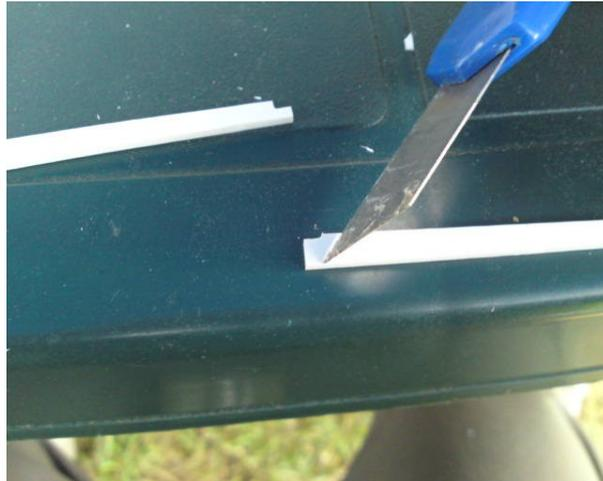
Zur Kontrolle ob der Motorhauben Ramen passt, setzen sie ihn kurz in den Motorhauben bereich des Fahrerhaus und korrigieren danach die Einzelnen Teile
