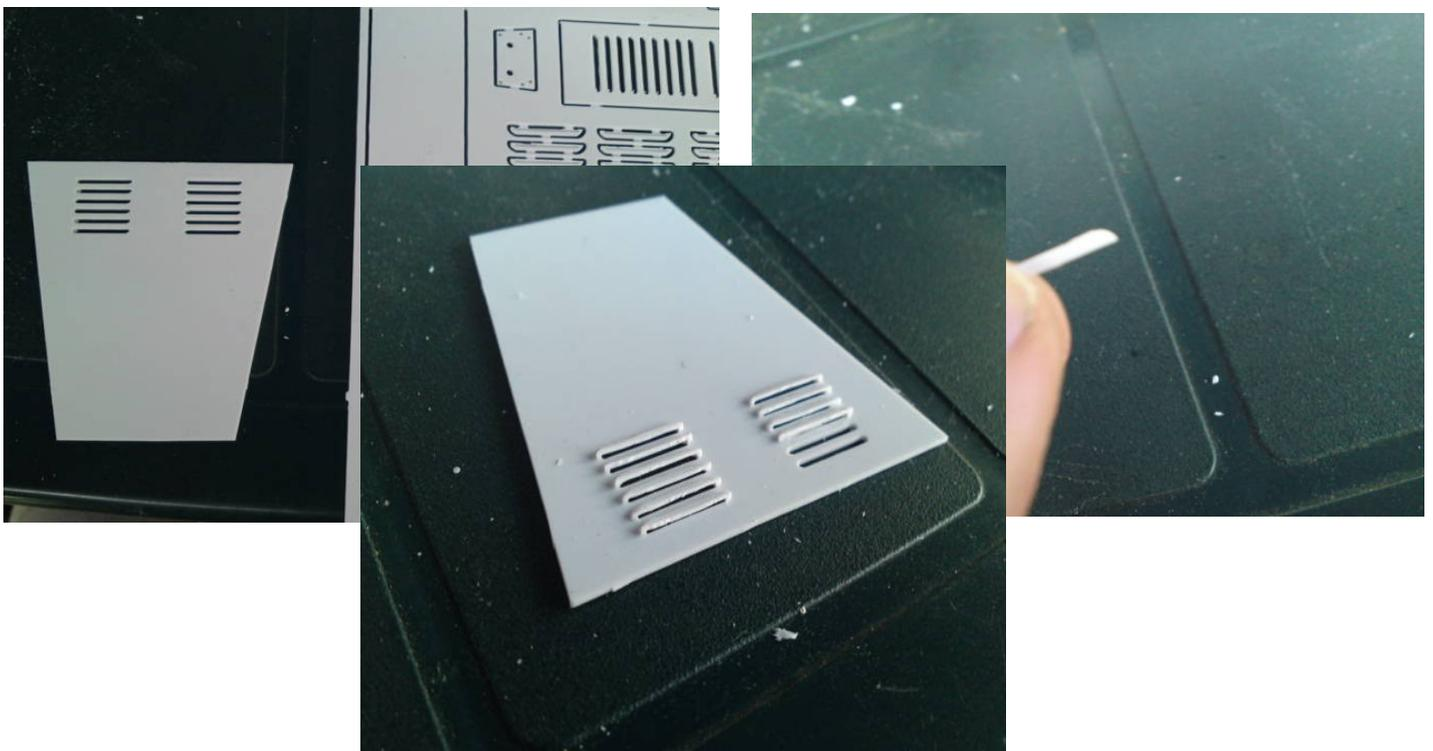
Trennen Sie dafür zunächst die Lamellen aus der Poly Platte und schleifen Sie die Außenkanten und die Vorderseite schön Run, danach kleben Sie die Lamellen, mit der Vorderseite leicht in der Aussparung der Motorhaube versenkt, ein
