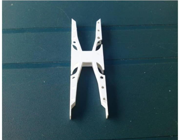
Nach dem Sie die beiden Strebenhälften mit einander verbunden haben, folgt das bohren der seitlichen Löcher. Dazu verwenden Sie einfach einen 4mm Bohrer und Bohren in die Markierungen. (siehe folgende Bilder)
