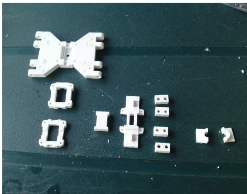
Jetzt Kleben Sie Stück für Stück die teile zusammen. Bei den beiden Gehäuse Mittelteilen sollte nach den Zusammenkleben das teil mit der Nut oben sein (siehe Bild).
