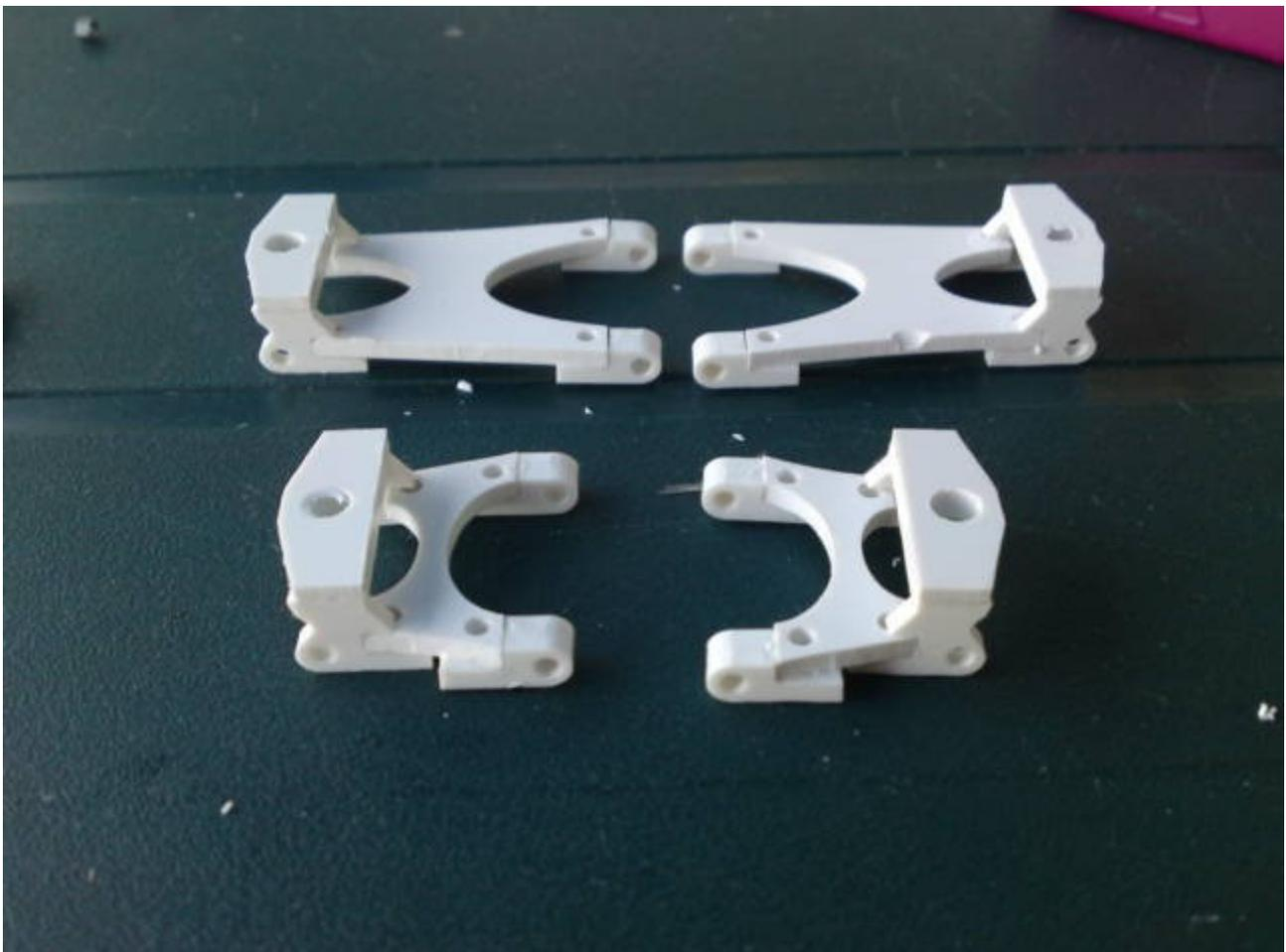
Achten Sie darauf das die Kugelkopfhalter bündig auf die Achsteile geschoben werden, dazu sollten Sie die Achsteile leicht abrunden damit man sie bis an den Anschlag der Kugelkopfhalter schieben kann.
