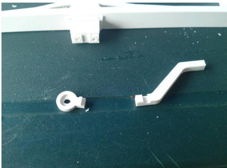
Beim einsetzen des Federarmtellers ist es wichtig das dieser leicht zum Federarm ende geneigt ist (nicht zum Federamlager).Dazu müssen Sie die Teile wie unten auf dem Bild zusehen leicht bearbeiten.
