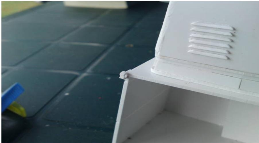
Nun schieben Sie die beiliegende Polystange durch die beiden Lager und setzen das Fenster mit der Ausfräbe von oben auf. Dabei kontrollieren Sie den richtigen Sitz des Fenster, es kann sein das links und rechts unten am Fenster die Lager aussparen müssen. Dies sollte einfach mit dem Messer erfolgen.
