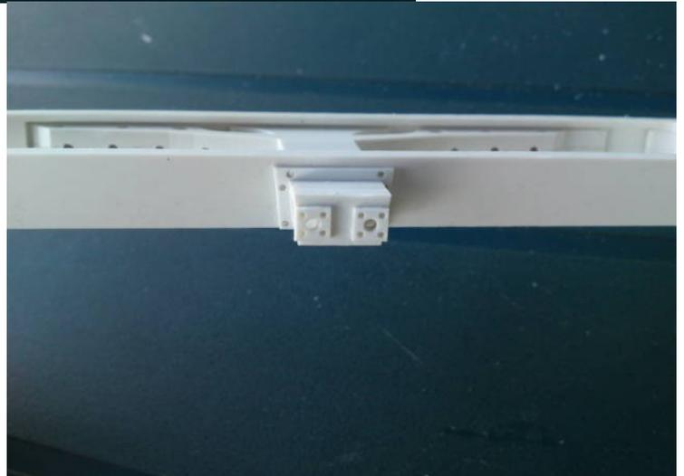
Bei Meinen Modellen habe ich nun immer durch die Federarmlagerung, beide Rahmenteile und die Rahmen strebe mit einen 2mm Bohrer durchbohrt um dann eine Gewindestange durch Lbeide Lagerungen und Federarme zu schieben.
