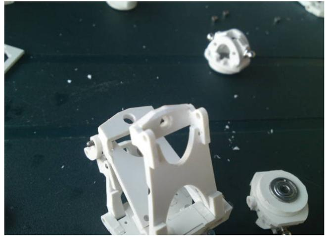
Nun folgt die Verbindung der Radlager mit den Achsteilen.
