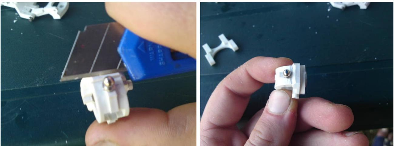
Ebenso sollten Sie die Außenkanten der Achsteile leicht abschrägen.
