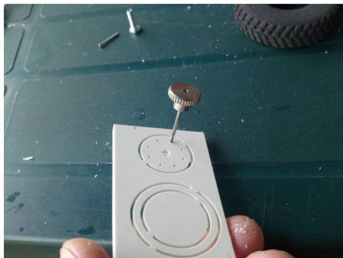
Danach drücken Sie die 3mm Sechskant schraube in die Mitnehmerscheibe, so das der Kopf bündig mit Versenkt ist.
