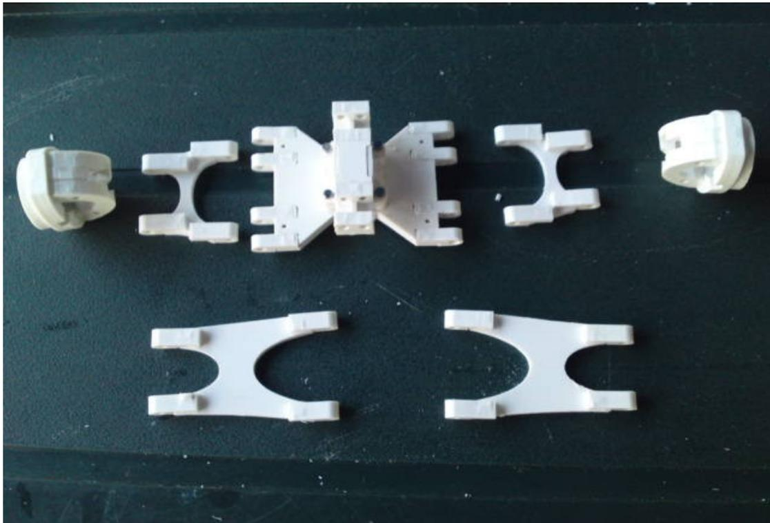
Nutzen Sie nun die 2x10mm Sechskant schrauben für die Langen Achsteile.
