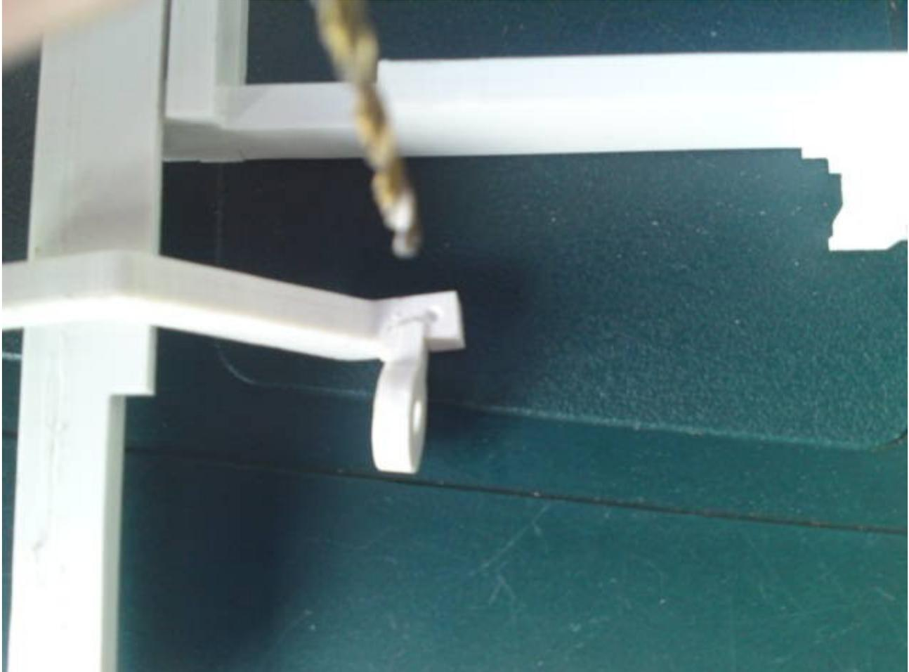
Nach dem die Bohrung sitzt schleifen Sie die Ecken des Lagerendes des Federarms leicht rund ohne dabei viel Material wegzunehmen und setzen Sie die Federarme in die Lagerungen ein.
